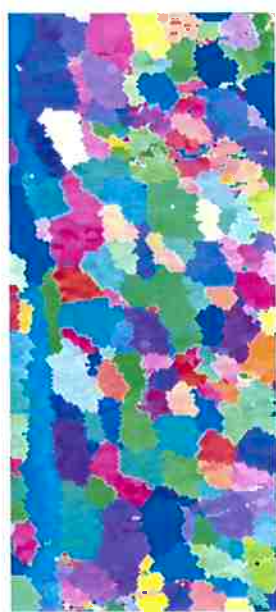
Figura 9 – Micrografia de orientação das amostras 6Cr-rec 3 recristalizadas em 5 minutos (a) e 20 minutos (b), com código de cores definido nas figuras anteriores.
