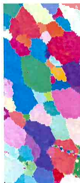
Figura 9 – Micrografia de orientação das amostras 6Cr-rec 3 recristalizadas em 5 minutos (a) e 20 minutos (b), com código de cores definido nas figuras anteriores.
